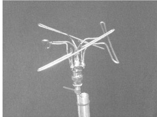
**Fig. 5:** Lindenblad Antenna.
